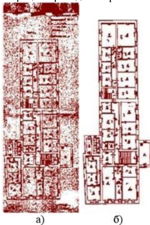
Рис. 2: а) исходное растровое изображение поэтажного плана здания в штриховом формате; б) результат его фильтрации объектовым фильтром
