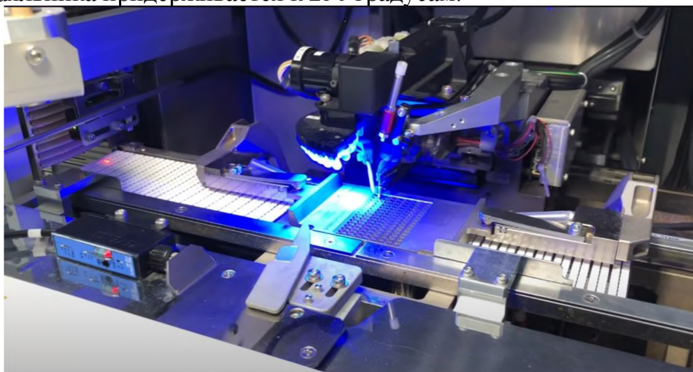
Рисунок 6: Процесс припаивания чипов к корпусам
