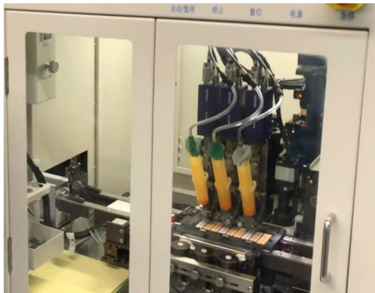
Рисунок 7: Процесс распыления смеси фосфора
