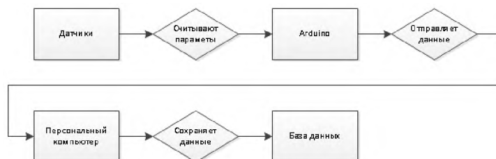
Рисунок 8: Модель системы сбора больших данных на уровне работы с данными
