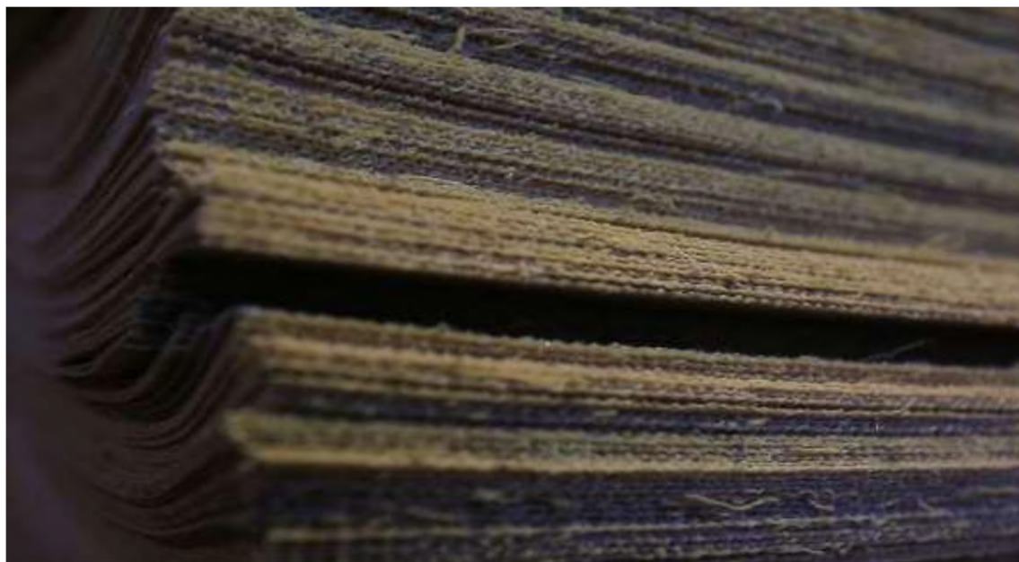
Рисунок 3: Пример текстолита (тканевая заготовка) в начале своего производства
