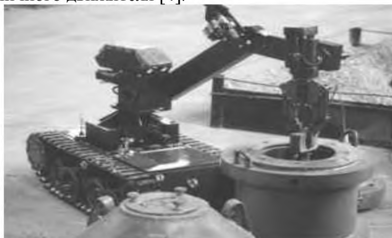
Рис. 5. Мобильный робот MV-4. Загрузка взрывоопасного предмета (противопехотной мины) во взрывозащитный контейнер
