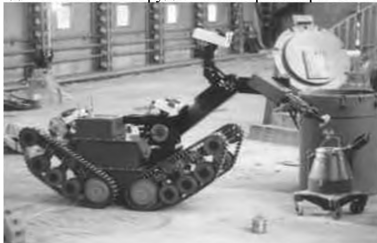
Рис. 4. Мобильный робот MV-3. Имитация загрузки радиоактивного предмета в специальный контейнер
