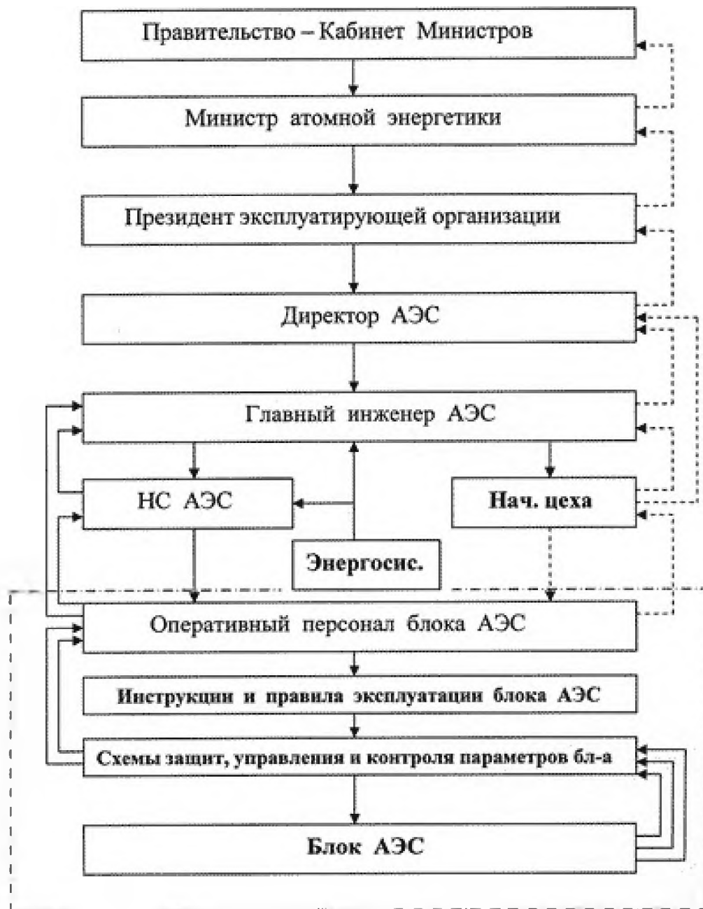
Рис.1. Блок-схема взаимодействия "управляющего сообщества" с блоком АЭС (штрих-пунктирной линией выделена блок-схема взаимодействия "человек-машина")
