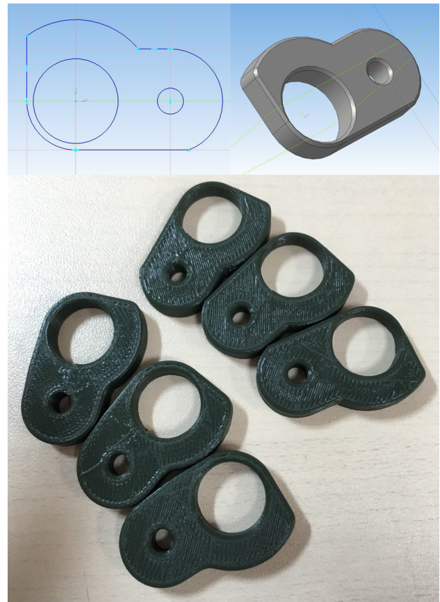
Рис. 2: Юстировочные упоры устройства для проведения хирургических операций: 3д модель и реализация на 3д принтере
